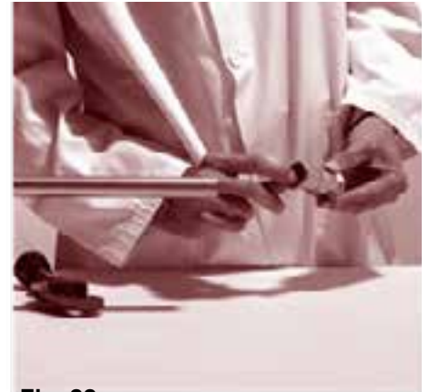
Fig. 22 Verifica della presenza e del posizionamento degli o-ring
