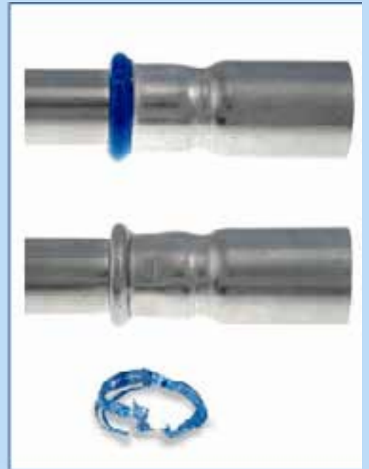
Fig. 5 Raccordo con sleeve prima e dopo la pressatura
