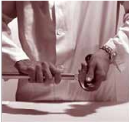
Fig. 21 Sbavatura dell'estremità dei tubi
