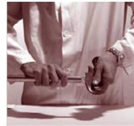
Fig. 21 Sbavatura dell’estremità dei tubi
