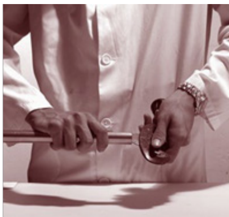
Fig. 21 Sbavatura dell'estremità dei tubi
