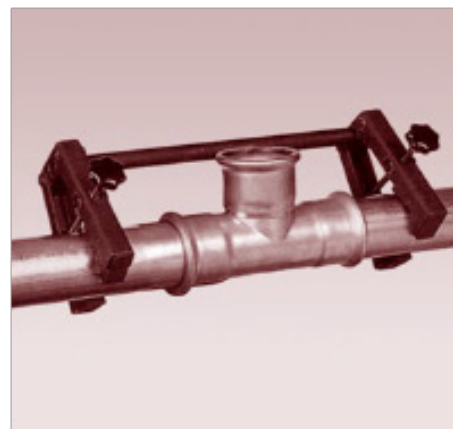
Fig. 25 Utilizzo della morsa di montaggio per diametri "Big Size"
