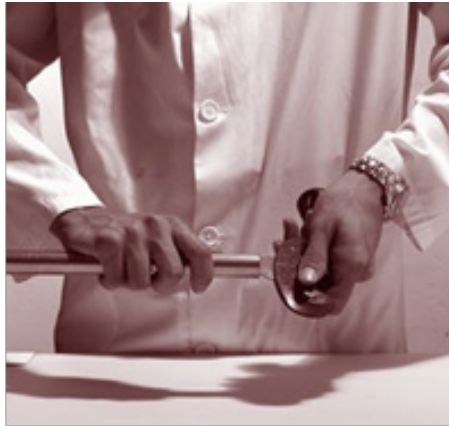
Fig. 21 Sbavatura dell'estremità dei tubi
