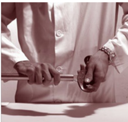
Fig. 21 Sbavatura dell'estremità dei tubi
